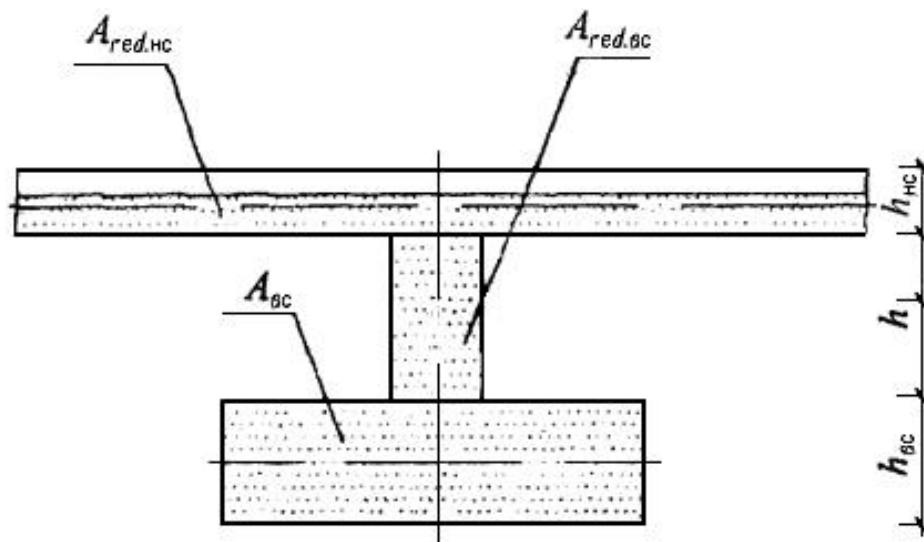
Рисунок 10 - Приведенное сечение рассчитываемого фрагмента стены
