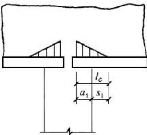
а - на средних опорах неразрезных балок при  $\alpha \leq 2s$ ; б - то же, при  $3s \geq \alpha > 2s$ ;
