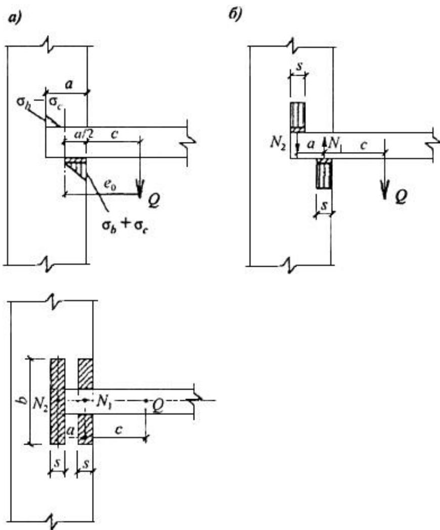
Рисунок 14 - Расчетные схемы заделки консольных балок
