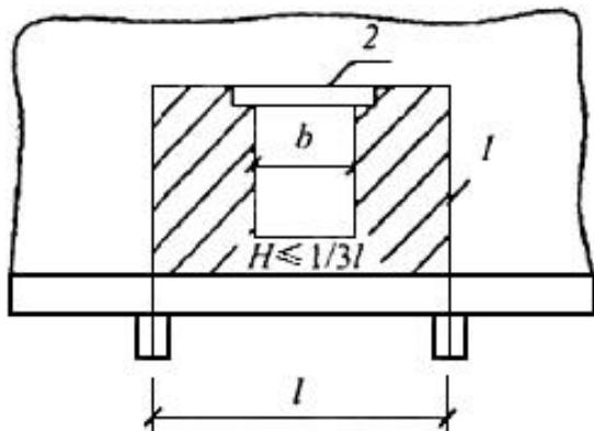
1 - нагрузка на рандбалку; 2 - железобетонная перемычка
